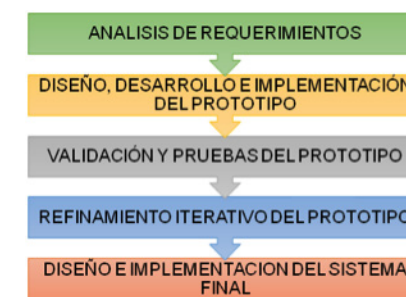
Fig. 1. Modelo de Prototipado Evolutivo, aplicando refinamientos sucesivos
